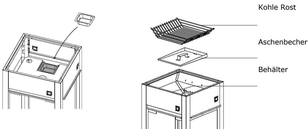
Wir empfehlen die Komponenten des oneQ Glow nach jeder Verwendung zu reinigen. Leeren Sie den Aschenbecher nach jedem Gebrauch. Überprüfen Sie alle Bereiche, in denen Öl, Fett oder Speisereste ansammeln, dann können alle Komponenten in optimalem Zustand bleiben. Wenn Sie Probleme mit Ihrem oneQ Glow oder (Ersatz) Teile bestellen wollen, kontaktieren Sie Ihren Händler oder besuchen Sie die [www.one-q.com](http://www.one-q.com), wo es einem umfassenden Kundenservice-Bereich gibst.
