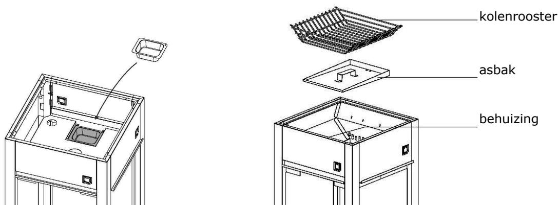
Wij adviseren om de onderdelen van de oneQ glow na elk gebruik te reinigen. Leeg na elk gebruik de asbak. Controleer alle plekken waar olie, vet of etensresten zich kunnen ophopen, dan blijven alle onderdelen in optimale conditie.
