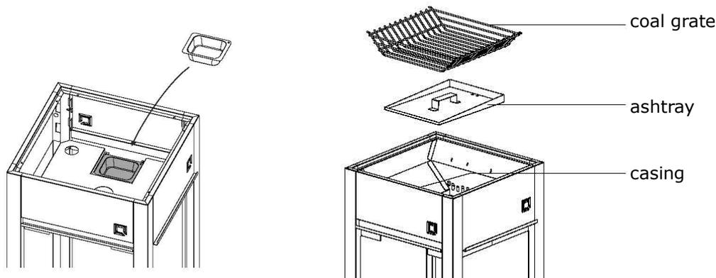
Vi rekommenderar att du rengör delar av oneQ glow efter varje anvandning. I om askkoppen efter varje användning. Kontrollera alla ställen där olja, fett eller livsmedelsrester kan ackumuleras, och alla komponenter förblir i optimalt skick.
