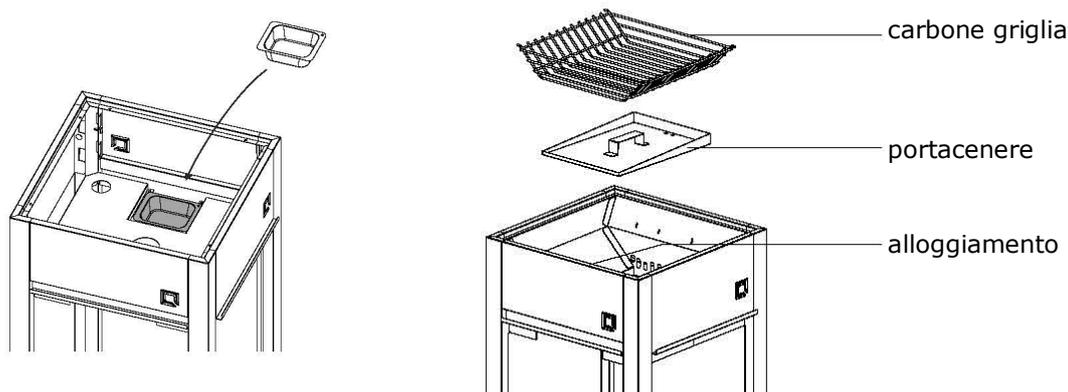
Si raccomanda la pulizia delle parti del bagliore oneQ dopo ogni utilizzo. Svuotare il posacenere dopo ogni utilizzo. Controllare tutti i luoghi in cui olio, grasso o residui di cibo si possono accumulare, quindi tutti i componenti restano in condizioni ottimali.
